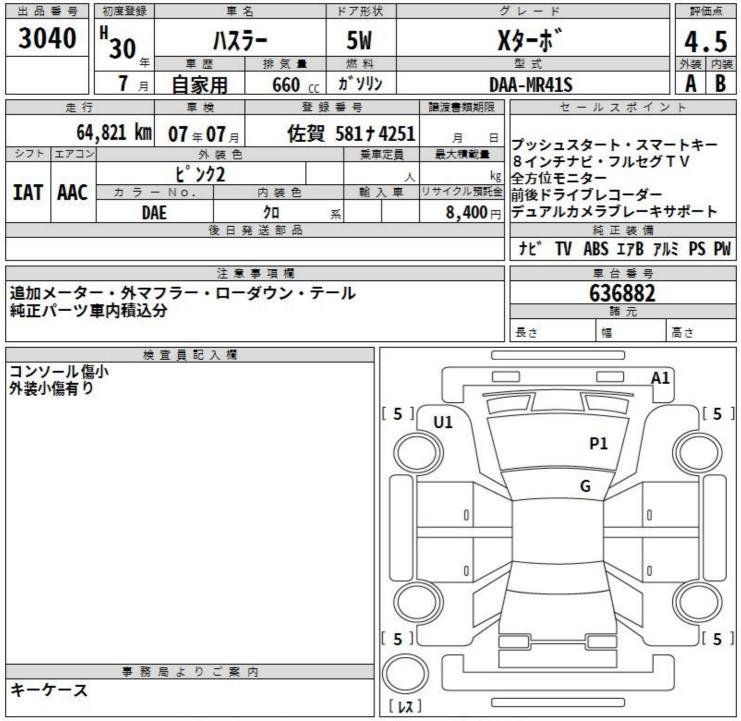
A:キス、U:ヘコミ B:キス、を伴うヘコミ P:要塗装 W:補修跡 S:錆 C:腐食 G:フロントガラス点キス、XX:交換済み X:要交換 内・外装評価 5段階ランク1頃(A+B+C+D+E) 1
